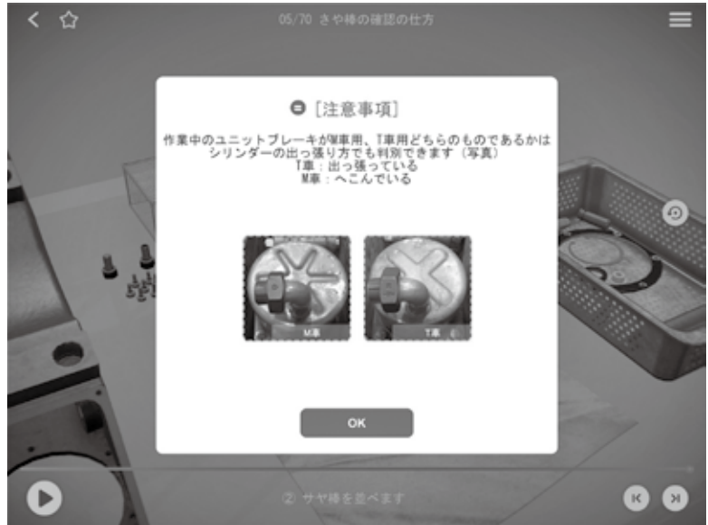
写真7 作業の注意事項やポイントを写真と文章で表示。確認後、OKボタンを押して次の工程へ進む
